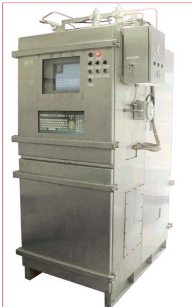
Figure 9. Online FTIR/Topnir analyser.
